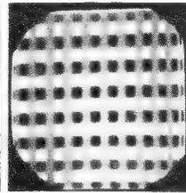
Bild 142. Zeilenraster bei Ausblendung mit einer niederfrequent modulierten Wechselspannung, beide Ablenkrichtungen linear
