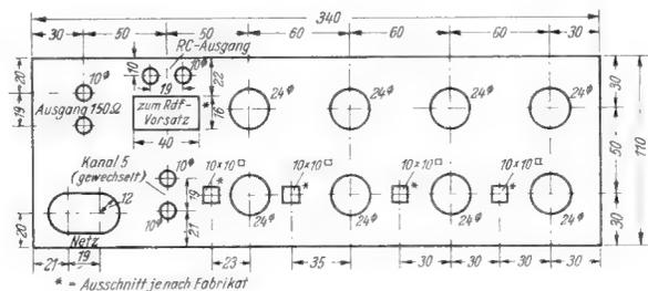
Bild 10. Maßzeichnung der Anschlußplatte (3-mm-Duralblech)
