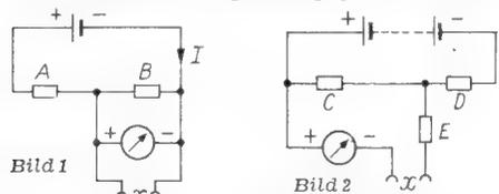
(1) Grundschialtung eines Ohmmeters zur Messung kleiner Widerstandswerte. X liegt parallel zum Instrument. (2) Grundschialtung eines Ohm-meters zur Messung großer Widerstandswerte. X liegt in Reihe mit dem Instrument
