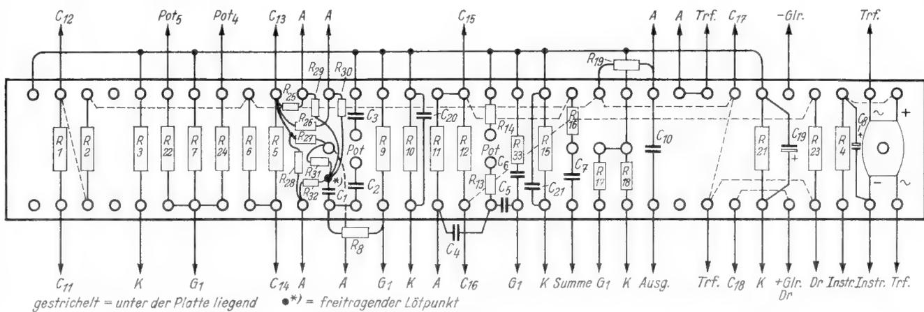
Bild 11. Lötösenbrettchen mit Schaltelementen (Die Positionsnummern entsprechen denen des Schaltbildes). Maße: 50 x 340 mm, Lötösenabstand waagrecht 10 mm, senkrecht 40 mm
