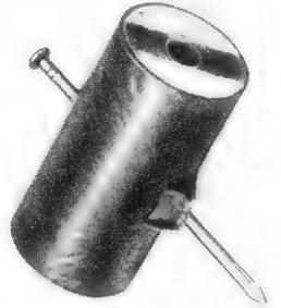
Bild 4. MP-Kondensator mit unter Spannung durchgeschlagenem Nagel. Der Kondensator blieb voll betriebsfähig
