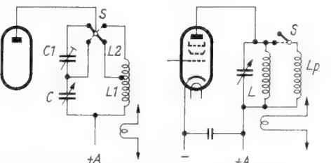
Bild 7. Änderung der Schaltung Bild 1 für Endstufen bis 50 Watt Hf-Leistung. S = hochwertiger keramischer Umschalter
