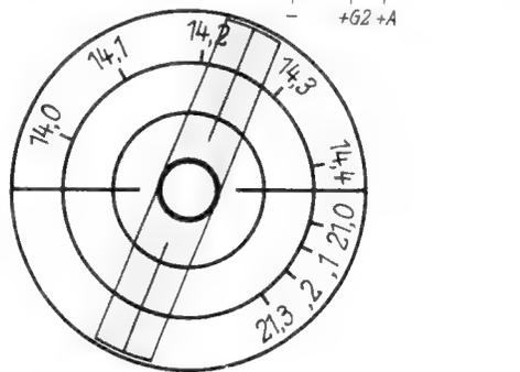
Bild 2. Skalenverlauf für 21 MHz bei unverändertem C
