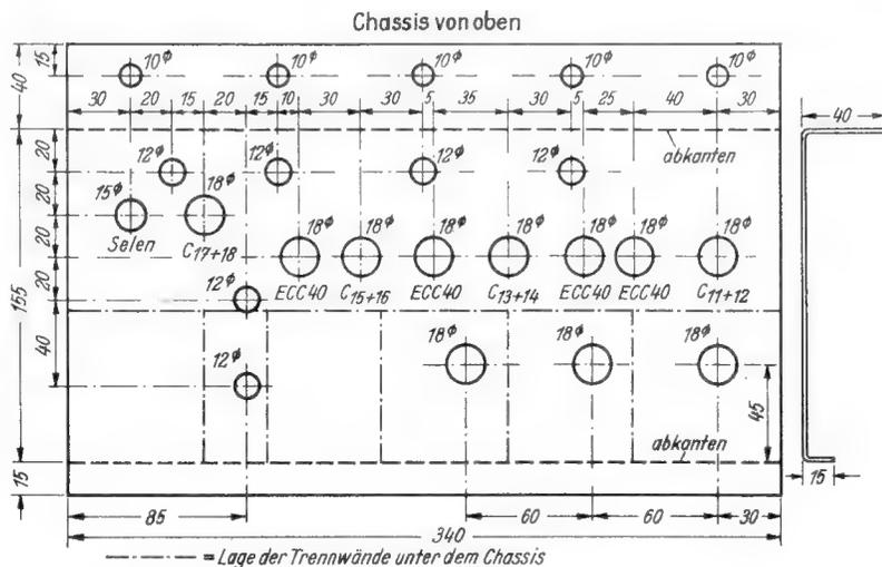
Oben: Bild 3. Chassisplan des Mischpultverstärkers. Die strichpunktierten Linien geben die spätere Lage der Abschirmwände an
