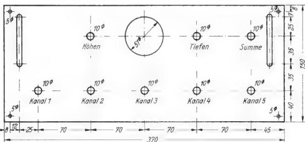
Bild 4. Maßzeichnung der Frontplatte des Mischpultverstärkers (3-mm-Duralblech)
