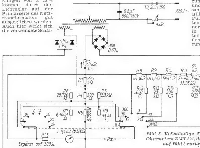
Bild 5. Vollständige Schaltung des Ohmmeters EMT 321, dessen Prinzip auf Bild 3 zurückgeht
