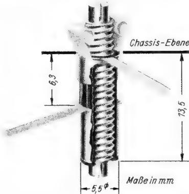
Schraubtrimmer für Höchstfrequenzen. Kleine Abmessungen gestatten kurze Leitungsverbindungen
