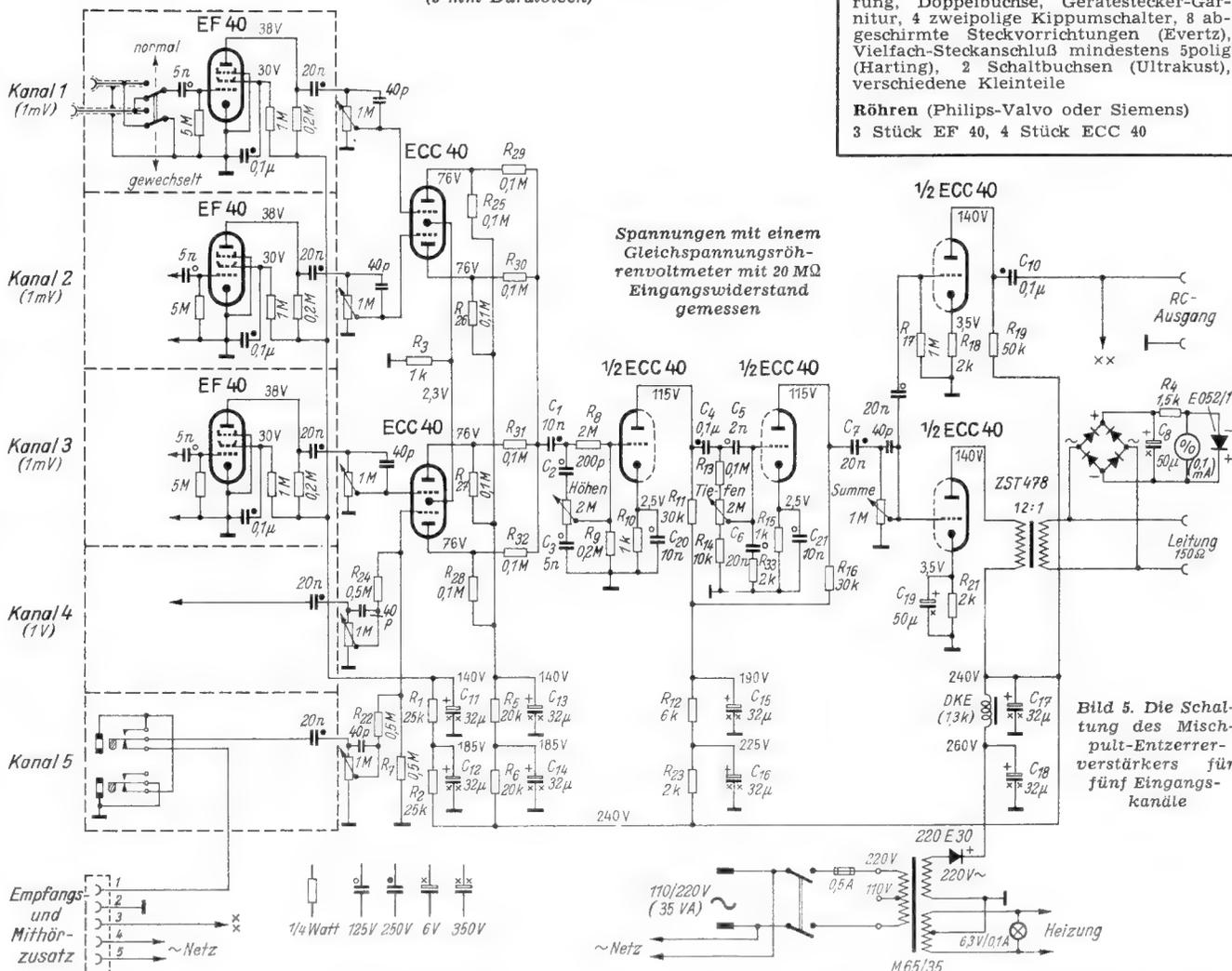
Bild 5. Die Schaltung des Mischpult-Entzerrerverstärkers für fünf Eingangskanäle
