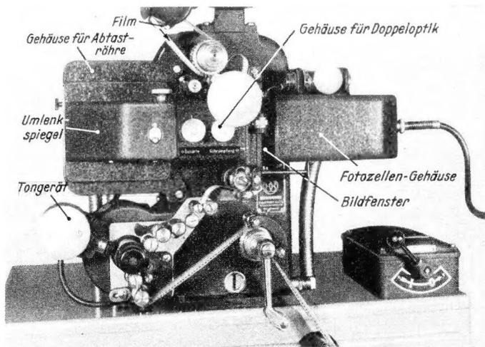
Bild 5. Abtasteinrichtung der Filmübertragungsanlage
