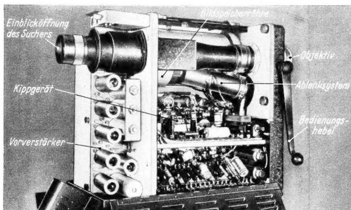
Bild 3. Fernsehkamera geöffnet
