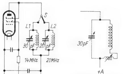
Bild 5. Umschaltung auf zwei getrennte Schwingkreise. S = normaler keramischer Schalter
