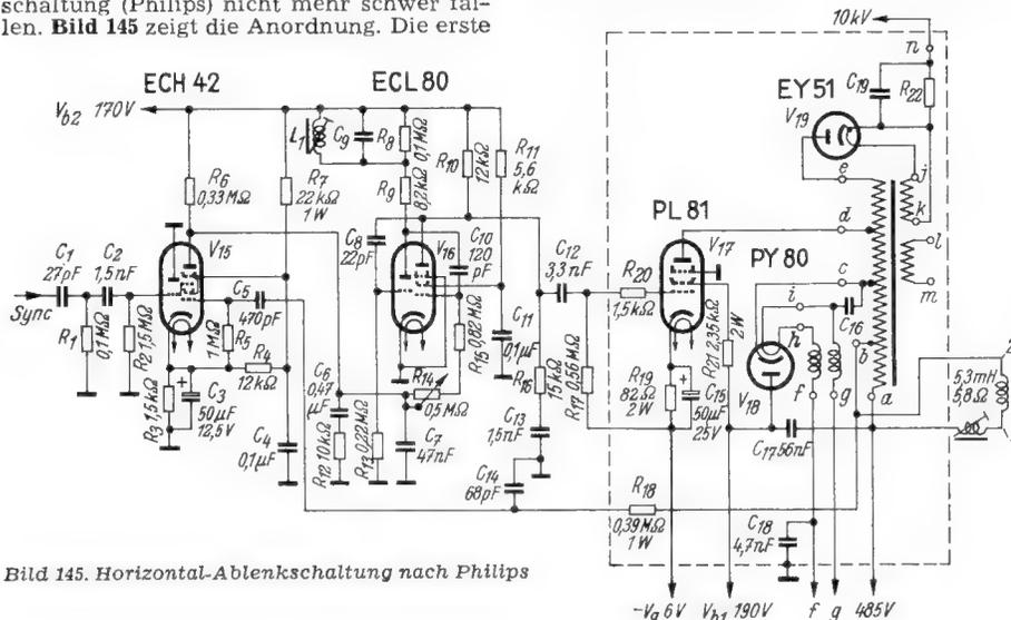
Bild 145. Horizontal-Ablenkschaltung nach Philips
