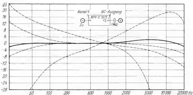
Bild 2. Frequenzkurven des Mischpultverstärkers bei verschiedenen Reglerstellungen
