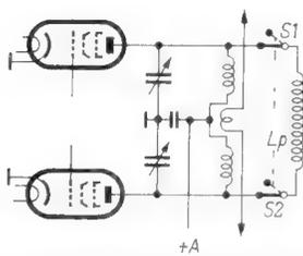
Bild 9. Umschaltung von Gegentakt-Endstufen über 100 W durch Parallelschaltung der Spule Lp. S1 und S2 = keramische Umschalter, miteinander gekuppelt
