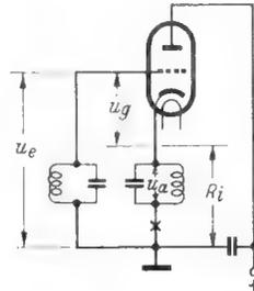
**Bild 42.** Anodenbasis-Verstärker. Die Anode ist wechselfspannungsmäßig geerdet, die Ausgangsspannung wird an der Katode abgenommen.  $\times$  Katodenwiderstand zur Erzeugung der Gittervorspannung
