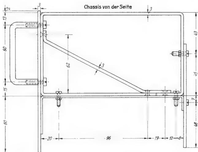
Bild 9. Zusammenbau des Chassis mit Front- und Anschlußplatte
