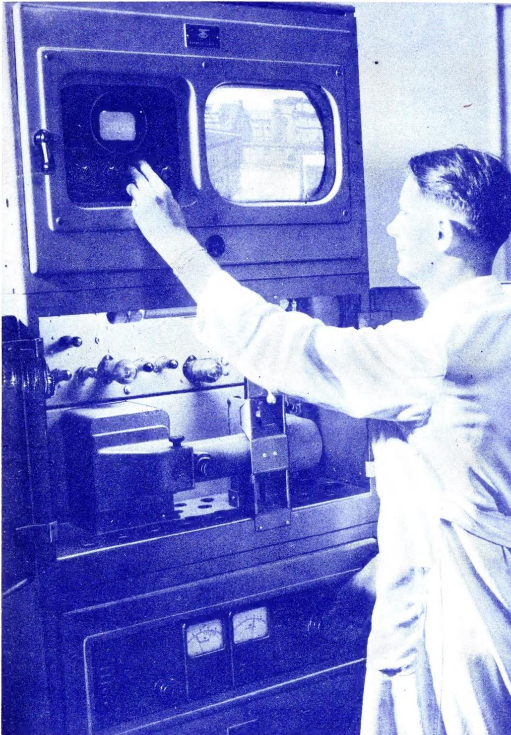
Der Diapositiv-Abtaster ist ein wichtiges Hilfsmittel zur Belegung des Fernsehprogramms und zur Durchgabe von Testbildern für die Überprüfung und Einpegelung des Senders. (Zum Aufsatz über Aufnahme-geräte der deutschen Fernseh-Studios auf Seite 417 dieses Heftes.)
