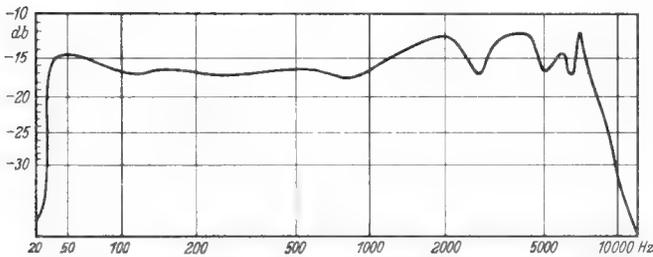
Bild 3. Frequenzkurve der Peiker-Kristall-Mikrofonkapsel G 36
