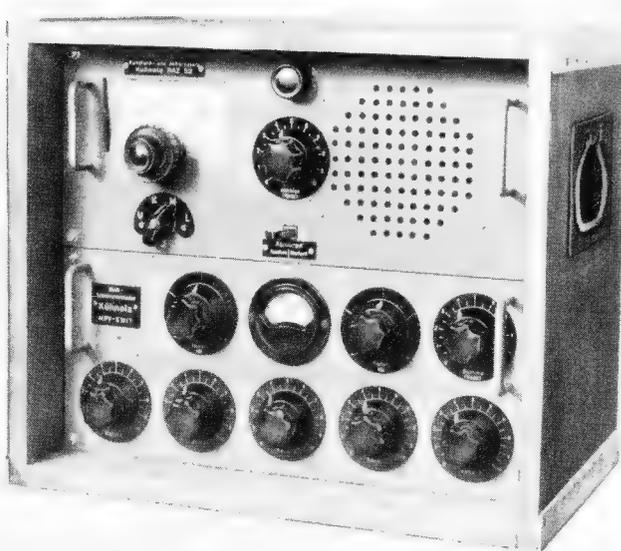
Bild 1. Mischpultverstärker (unten) und Rundfunkzusatz (oben)
