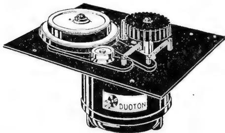
4/211 DUOTON-Triebwerk, Modell AM 52/II. Der gleiche Motor ist bei diesem Triebwerk bereits mit einem Tonrollentrieb montiert. Der Antrieb wird durch einen Drehknopf ausgerückt. Freier Bandrücklauf. Der Antrieb der beiden Tonrollen für 19 oder 38 cm/sec erfolgt
