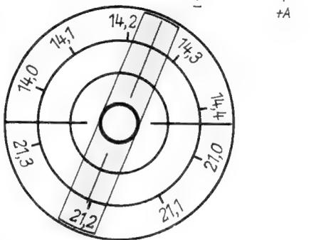
Bild 4. Skalenverlauf für 21 MHz bei geändertem C
