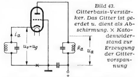
**Bild 43.** Gitterbasis-Verstärker. Das Gitter ist geerdet u. dient als Abschirmung.  $\times$  Katodenwiderstand zur Erzeugung der Gittervorspannung
