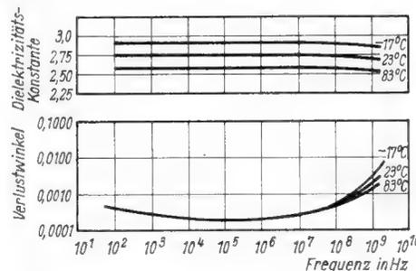
Abhängigkeit der Dielektrizitätskonstante und des Verlustwinkels von der Frequenz und der Temperatur bei Silikon-Ölen vom Typ DC 200
