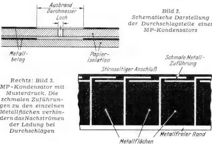
Rechts: Bild 3. MP-Kondensator mit Musterdruck. Die schmalen Zuführungen zu den einzelnen Metallflächen verhindern das Nachströmen der Ladung bei Durchschlägen
