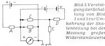
Bild 3. Vereinigung der Schaltung von Bild 1 und 2 zur Umkehrung der Skalen-teilung bei der Messung großer Widerstandswerte
