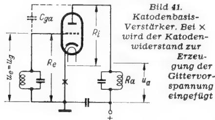
**Bild 41.** Katodenbasis-Verstärker. Bei  $\times$  wird der Katodenwiderstand zur Erzeugung der Gittervorspannung eingefügt
